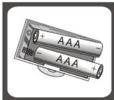
Ese aparato funciona con 2 pilas de 1.5V de tipo AAA (no incluidas). Para instalar, quite la tapa de emplazamiento de las pilas ubicada en la parte inferior de la balanza. Introduzca la pila, asegurándose de respetar la polaridad indicada en el compartimiento de las baterías; luego ponga la tapa. Ahora se puede utilizar su balanza.
